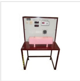
Lagged Pipe Apparatus
